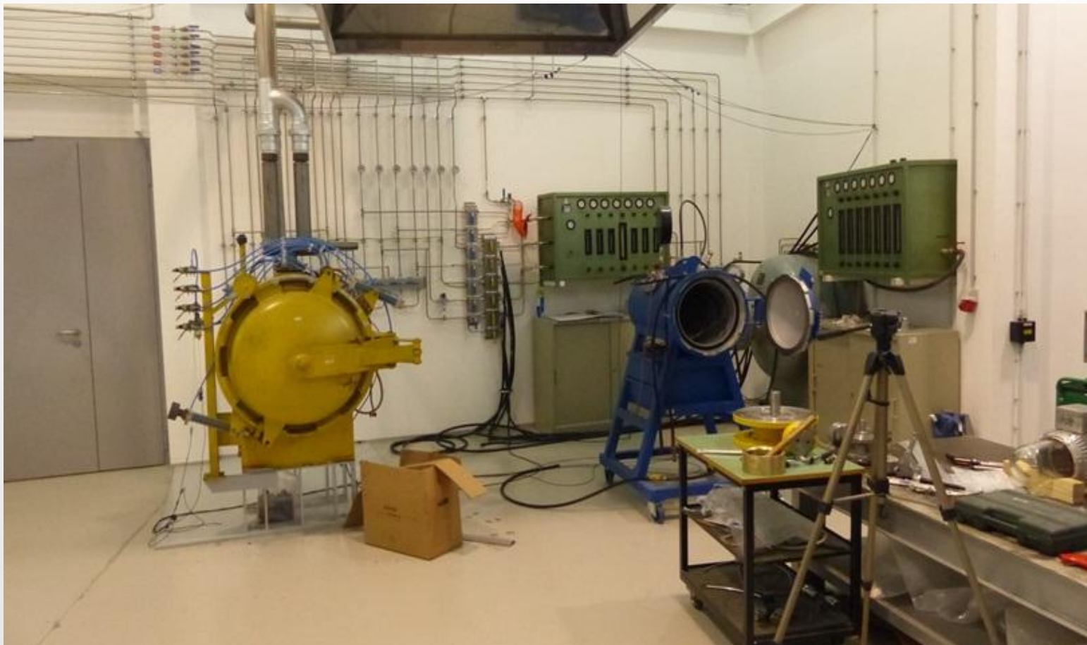
Miješalica plinova za ispitivanja "Ex d" uređaja u laboratoriju
