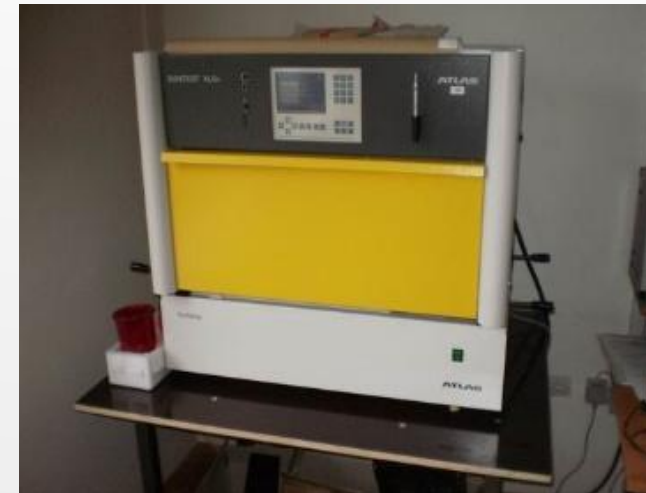
Ispitivanje otpornosti na svjetlo- UV zrake
